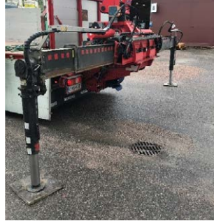
2. Levitä tukijalat ja aseta suojalevyt tukijalkojen alle.
