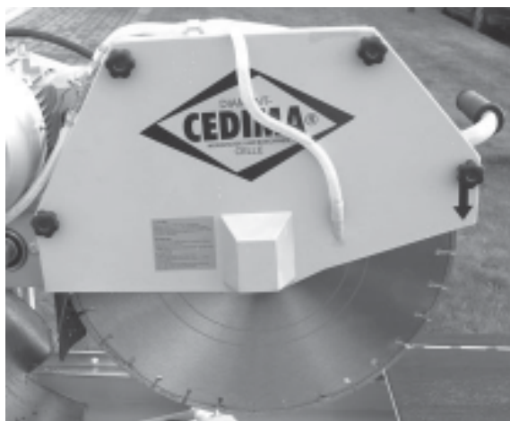
CTS-175. Suojakotelon kansi asennetun timanttilaikan yllä
