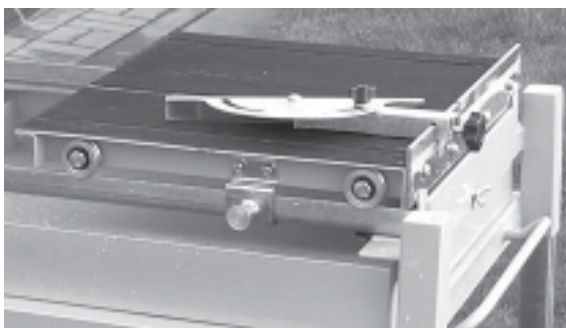
CTS-175. Rullapöytä on asennettu, kulmavaste on asennettu.
