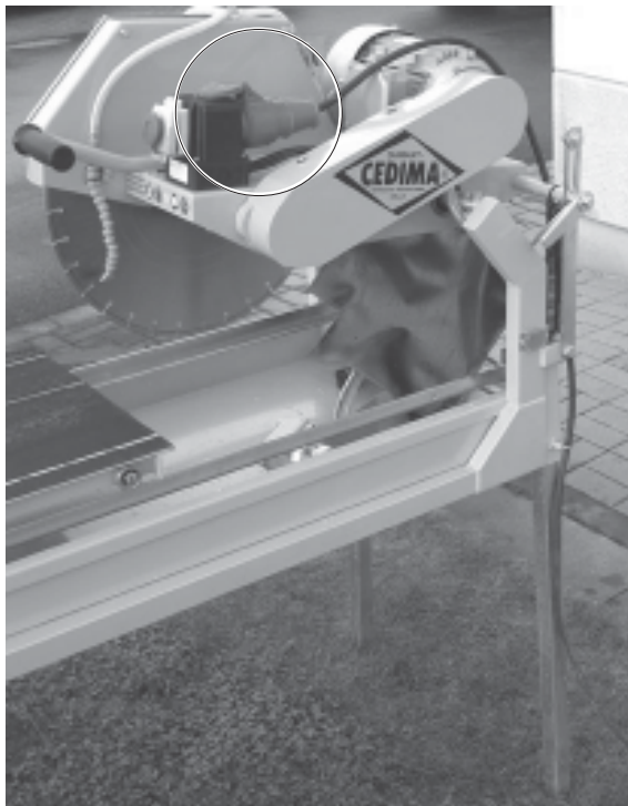
CTS-175. Verkkokaapeli 230 V on kytketty
