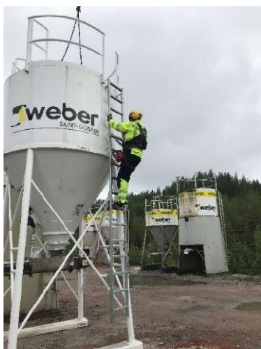
10. Kiipeä siilon päälle käyttäen putoamissuojausta. Katso erillinen kiipeämisohe.
